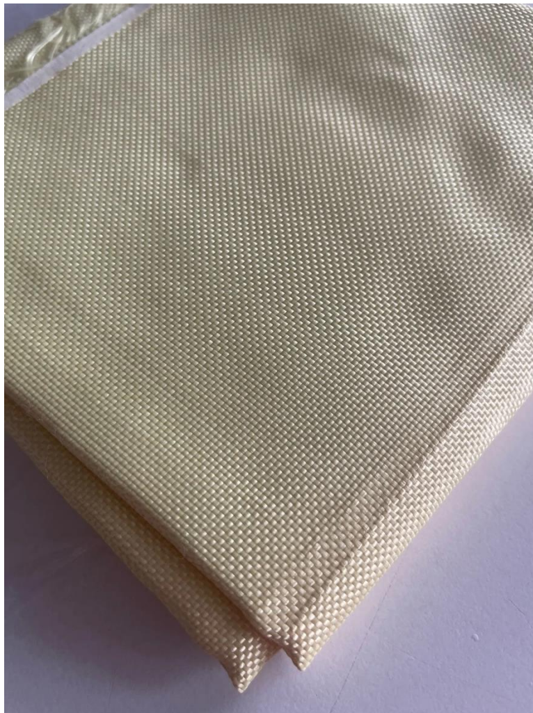
Tissu tissé en fibre aramides 240g pour gilet pare-balles (Crédit : Alitools.io)
